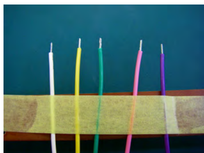
マスキングテープを使った リード線の固定
